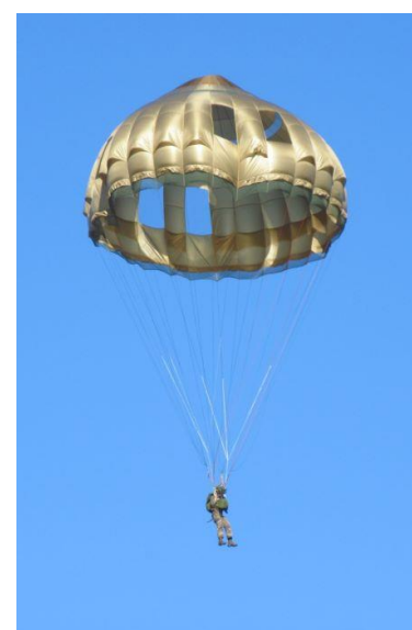
L'EPC (Ensemble de Parachutage du Combattant – 115 m 2 - 160 kg de charge
